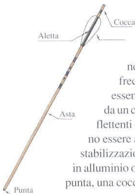
L'arco è un trasformatore di energia: converte cioè la forza muscolare dell'arciere nell'energia cinetica della freccia. Nelle sue parti essenziali l'arco è costituito da un corpo centrale (riser), due flettenti e una corda, a cui possono essere aggiunti un mirino e una stabilizzazione. La freccia è un'asta in alluminio o carbonio, munita di una punta, una cocca e tre alette.
